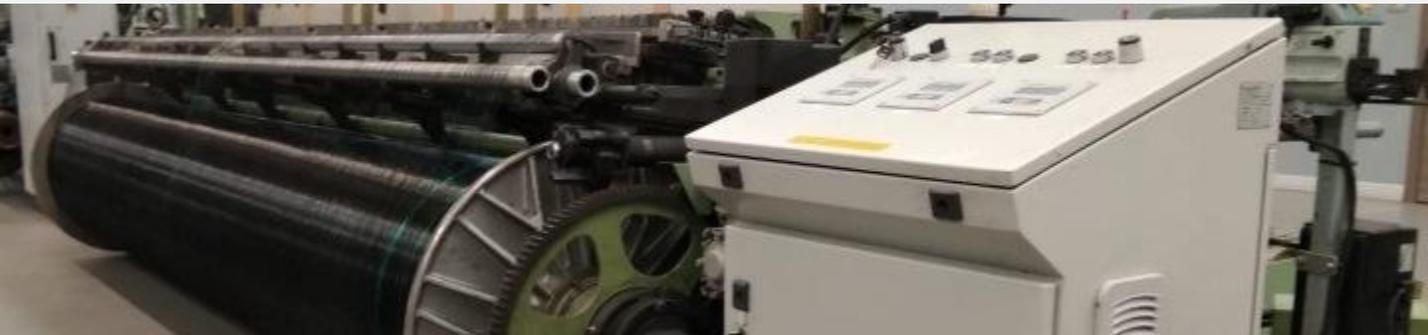
**KAST-ERGO Steuerung, für bis zu 4 Achsen, die entweder für
