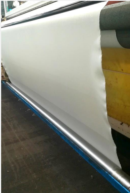
Airbag gewoben ohne Kantenfadenablasser
