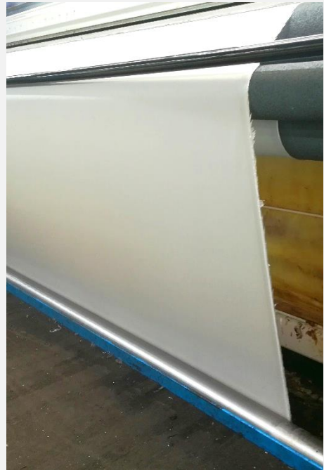
Airbag gewoben mit Kantenfadenablasser
